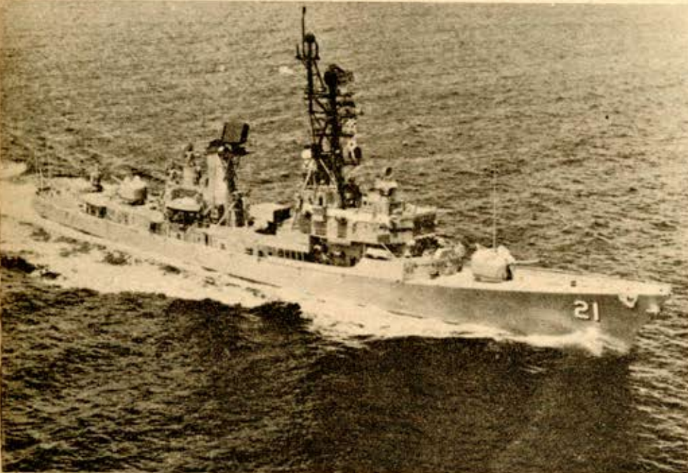
destructor norteamericano equipado con material electrónico de rastreo, radares y sensores ultra-precisos. también se les emplea para la recuperación de astronautas y aparatos espaciales que regresan a la tierra.
