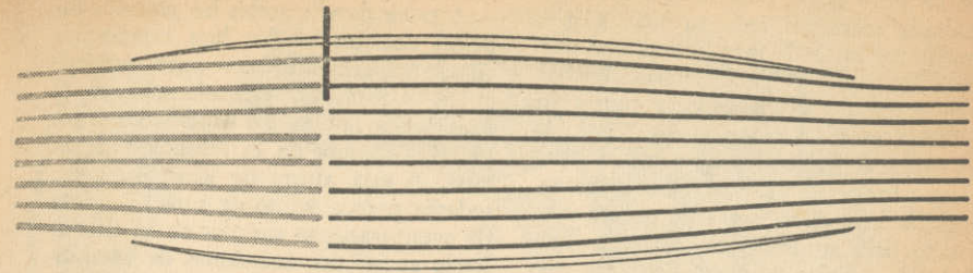
Esquema simplificado de una de las formas de propulsión a chorro. El aire que entra en el motor por la izquierda es calentado mediante la inyección de combustible. Esto aumenta la velocidad del gas y produce el impulso que mueve al vehículo.
