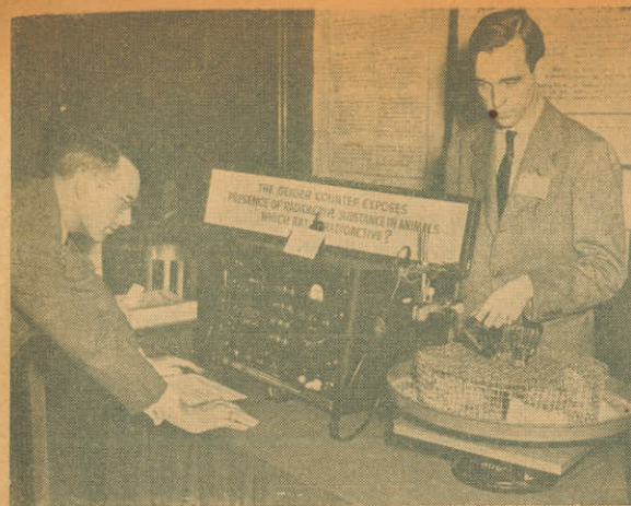
RATAS RADIATIVAS.— Nueva York: mientras comprueban la efectividad del Contador Geiger en la medición de la radiactividad, científicos de la Asociación Científica para la Educación Atómica, usan dicho instrumento para determinar cuál de las ratas de la jaula ha sido contaminada con yodo radiactivo.
