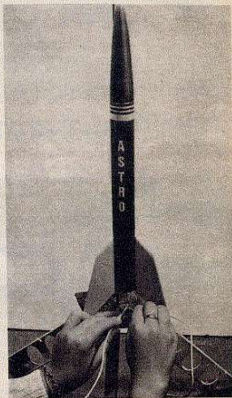
7 El propulsor se ubica en el interior de la celda propulsora (tubo de cartón, fijado y centrado dentro del fuselaje).
