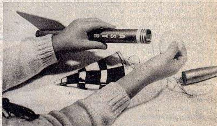
4 Para la expulsión del paracaídas se debe colocar como "pistón" un trozo de algodón entalcado.
