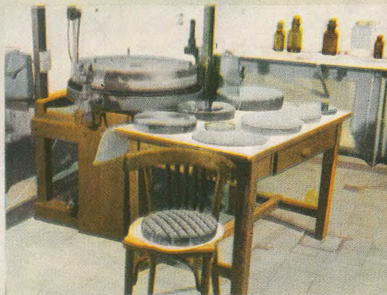
Máquina de pulir con el objetivo de 90 cm. Al lado, distintas piezas ópticas hechas en el Observatorio. En primer plano, herramienta de pulir.
