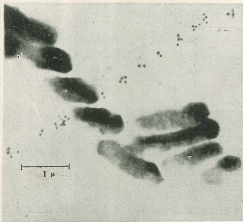
Fig. 8. — La fotografía superior muestra el trazo de una partícula Beta con una energía de aproximadamente 1 MeV. La ionización ocurre en forma de agrupaciones separadas por espacios de aproximadamente 1 micrón y en los cuales no se observa la formación de iones. La separación lateral de los iones está magnificada por haberse aplicado un campo eléctrico para provocarla y hacer más evidente esta separación entre los iones. En la fotografía inferior, el trazo de la fotografía superior está superpuesto sobre una fotomicrografía obtenida con microscopio electrónico, de bacilos Coli (según L. H. Gray)
