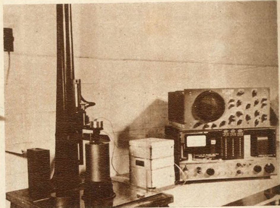
Sistema para medir yodo radiactivo en flúidos. Se puede observar que el tubo contador de radiaciones se encuentra protegido por un dispositivo de plomo y conectado, en el caso, a un escalímetro decimal.
