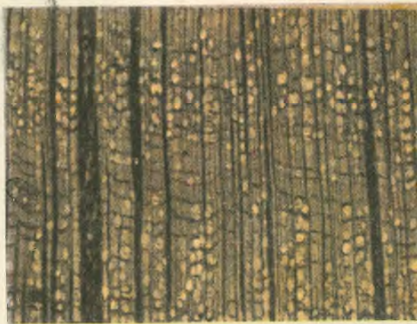
Corte transversal de la "casuarina" ( C. cunninghamiana ). Esta latifoliada también posee grandes radios (zonas oscuras) y entonces exhibe un hermoso "jaspeado". Aquí es característico el parénquima vertical (pequeñas líneas oscuras).
