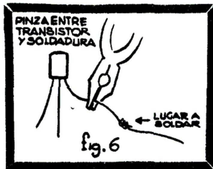
letrae B, E y C respectivamente. Si sueldan los componentes tengan cuidado de no calentar mucho los alambres del transistor y el diodo. Para derivar el calor apríéntenlo con una pinza en el momento de la soldadura como indica la figura 6. Para terminar les aconsejo hacer primero el receptor sin la pila ni el transistor y luego de haber experimentado con él durante un tiempo y lograr buenos resultados, agregarle la segunda parte, ya que lo único que se conseguirá con ella es amplificación.
