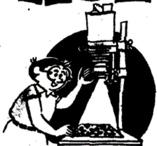
2 CORTAR UNA TIRITA DE UN CENTÍMETRO DE ANCHO DE PAPEL SENSIBLE PARA CALCULAR EL TIEMPO DE EXPOSICIÓN
