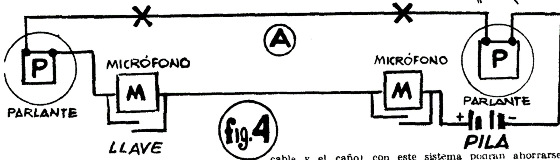
cable y el caño) con este sistema podran ahorrarse el cable A y el intercomunicador funcionará con un cable sólo.
