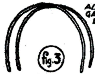
ALAMBRES GALVANIZADOS DE 40 CMS DE LARGO CURVADOS PARA FORMAR EL CABEZAL.
