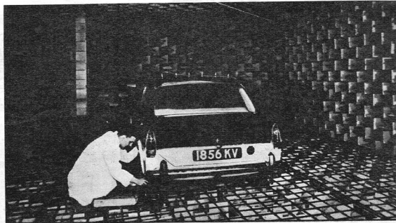
Esta sala, construida para medir los ruidos de los autos, está hecha de modo que no hay reflexiones sonoras en una vasta gama de frecuencias. Es la "sala del silencio", las paredes, el techo y el piso están contruidos de un intrincado mosaico de fragmentos de gomapluma.
