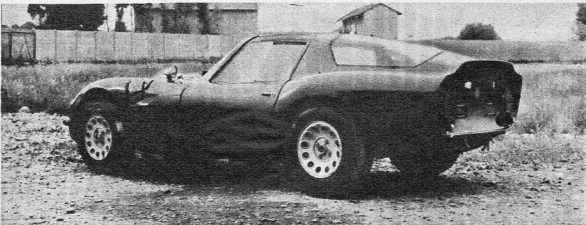
El "Giulia TZ2" presenta la cola trunca para facilitar el desplazamiento del aire a altas velocidades. El frontal se levanta completamente por delante.
