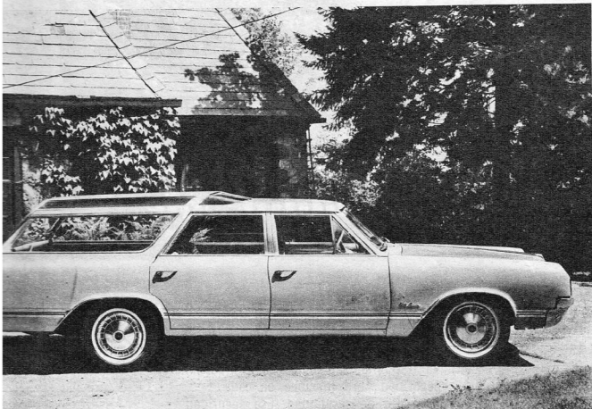
VISTA-CRUISER, con motor Jetfire V-8, tiene una capacidad de carga de casi 3 metros cúbicos.
