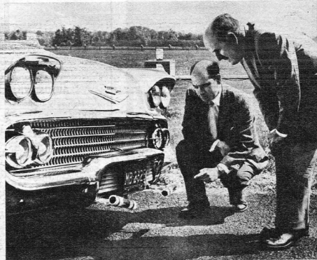
Los ingenieros examinan las bobinas de detección por medio de las cuales se registran los órdenes de los transmisores enterrados en el camino.
