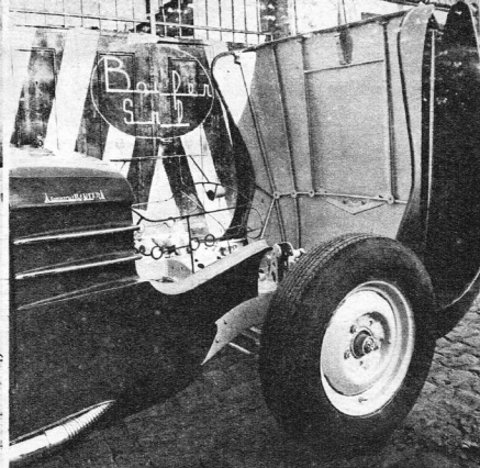
El capot, de fácil acceso, está sostenido con una bisagra sin bulón, ni tuercas, ni chavetas, que permite desplazarlo hacia un costado y también, retirarlo totalmente.
