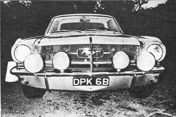
El frontal del Ford "Mustang" preparado para carreras y utilizado para la prueba en carretera; nótese los grandes faros suplementarios y la taja de seguridad para la cubierta del motor.
