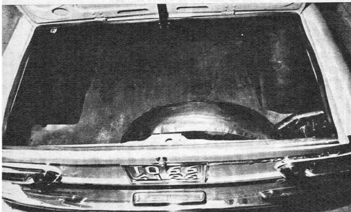
La capacidad del baúl del "Fulvia 2 C" es muy grande, tanto por la notable altura como por la original disposición vertical de la rueda de auxilio.
