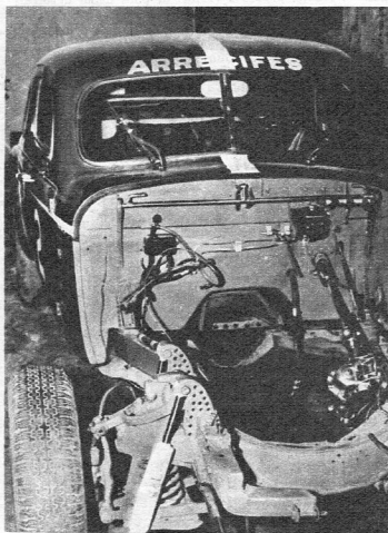
Un vacío que pronto se ha de llenar. El TC de Carlos Paireti espera la ubicación, sobre sus soportes, del nuevo motor "siete bancadas".
