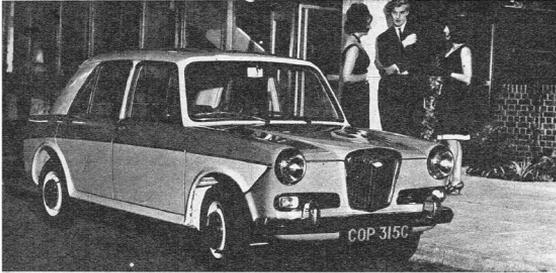
El nuevo Wolseley 1.000 dispone ahora de 55 HP de potencia, con una relación de compresión de 8,9-1, de un cambio de 4 marchas sincronizadas y de la transmisión Hydrolastic.
