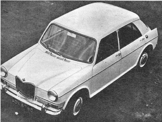
También el Riley Kestrel fue equipado con el motor de cuatro cilindros de 1.098 cc, alimentado por dos carburadores. La baja línea media de la carrocería le confiere una excelente visibilidad.
