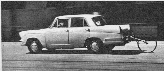
En la prueba de velocidad máxima el velocímetro nos mintió en un 7%: la mejor pasada registró 137 km/h; el promedio, 135 km/h.
