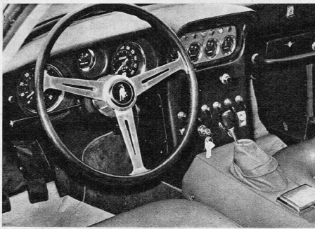
El nuevo tablero del 400 GT 2 + 2: sobre la consola central, y en un pequeño panel de abajo, los indicadores de temperatura de agua y aceite, nivel de nafta y aperímetro. Bajo el volante, cuentavolts, marcador de presión del lubricante y velocímetro. La corte palanca de cambios es el nexo entre el conductor y la excelente caja de cinco marchas que ahora produce el mismo Lamborghini, caracterizada por su funcionamiento suave y preciso.
