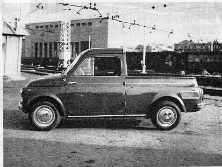
El "500 Baby" es un camioncito que utiliza los portes mecánicos del Fiat 500 que, por su maniobrabilidad, por las dimensiones de su caja y por su capacidad de carga (alrededor de 400 kg) resulta un vehículo ideal para el transporte de cargas pequeñas en el denso tránsito urbano.
