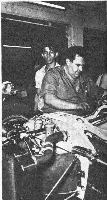
Pedro Bronenberg, de breve pero resonante incursión en el lastro mundial, dedica su atención a instalar el instrumental. Se observan detalles del primer punto de unión, y de las mangueras y caño que llevan el agua del radiador al motor.
