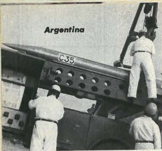
Una grúa de movimientos lentos coloca el Centauro sobre la rampa: un error sería fatal.
