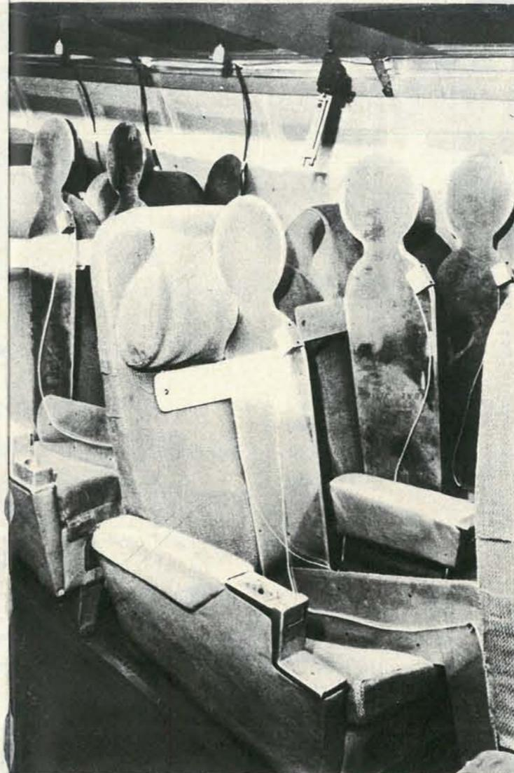
Antes de realizar en el Concorde la experiencia con seres humanos, se realizaron muchos con estos singulares maniqués metálicos. Los cables están conectados con termómetros que transmiten al exterior la temperatura y que se han colocado en todas partes en el fuselaje. Más tarde se realizaron ensayos con personas, protegidas por una doble pared en el interior de un fuselaje modelo. El único comentario: "La temperatura nos pareció agradable."
