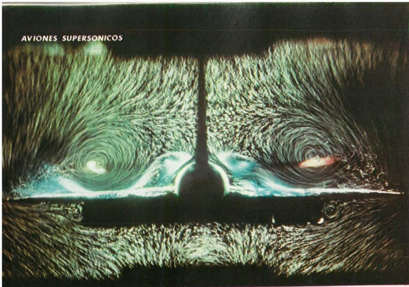
Esto es un aterrizaje del Concorde. La experiencia tuvo lugar en un túnel hidráulico, construido especialmente en Châtillon, cerca de París, para estudiar el comportamiento del avión a bajas velocidades. Partículas coloreadas mezcladas con el agua permiten percibir los remolinos y corrientes que se forman alrededor del aparato. Resultado: el ala triangular permite descender sin inconvenientes. Para llegar a esta conclusión, se sacaron más 200.000 fotos.
