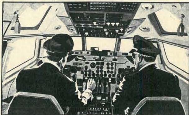
LA DUPLICIDAD EN LOS SISTEMAS AUMENTA LA SEGURIDAD DE LAS SALIDAS. El DC-9 tiene un equipo eléctrico dividido, y sus sistemas hidráulicos, de aire acondicionado y de frenos, son dobles y completamente independientes. Esto es característico del interés de Douglas en garantizar el más alto porcentaje de salidas a horario.
