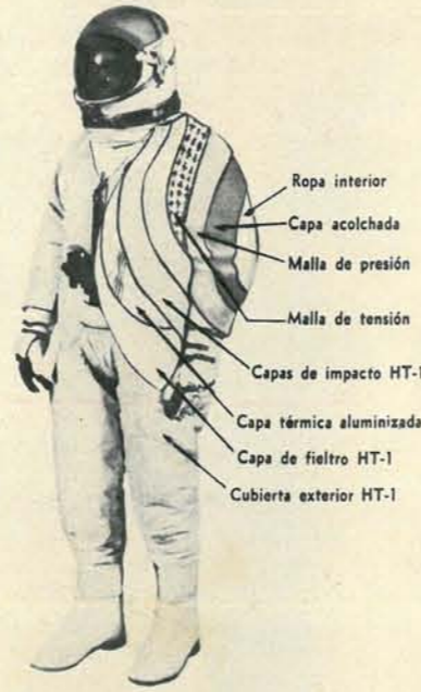
Arriba: En los trajes del futuro, ocho capas protegen a los astronautas de todas las contingencias. En los laboratorios de la NASA (abajo) un técnico prueba el traje que pasará por el cosmos. Al costado, el guardarrapa espacial; el primer traje es el de McDivitt.
