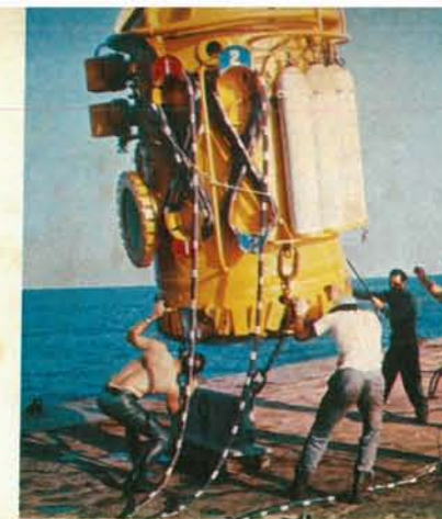
El Cachalot puede llevar dos buzos a 200 metros de profundidad y traerlos a la superficie sin pasar por el lento proceso de descompresión.
