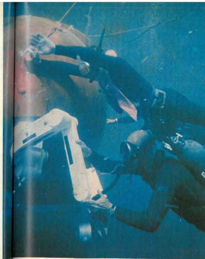
El brazo mecánico del DOWB puede realizar movimientos delicados y levantar pesos considerables. Su funcionamiento se controla a través de una cámara de televisión.
