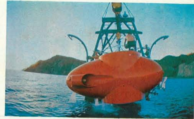
La empresa General Motors también proyectó un submarino oceanográfico, el DOWB, que lleva dos tripulantes y puede descender hasta los 2.000 metros.
