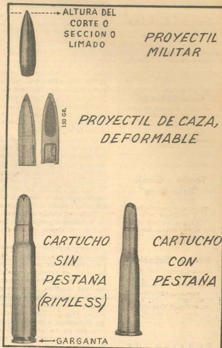
Figuras 2, 3 y 4. - Proyectil militar re-formado, proyectil de caza deformable y cartuchos con y sin pestaña.
