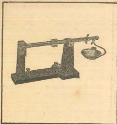
Figura 12. - Balanza para medir pólvora (Power Scale).
