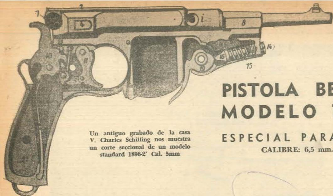
Un antiguo grabado de la casa V. Charles Schilling nos muestra un corte seccional de un modelo standard 1896-2' Cal. 5mm
