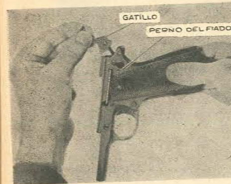
Figura 14. — Quite el gatillo desde la corredera. Deslice el perno de la palanca del gatillo y separe las partes (fig. 19). (Si el perno está remachado no tocarlo). Saque el perno del fiador desde el lado izquierdo de la corredera. Coloque la pistola con la parte delantera hacia arriba y reciba en la mano el fiador y el desconector.
