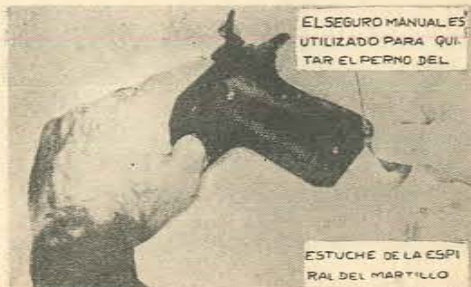
Figura 10. — Sujete el gatillo, presione la cola del disparador y déjelo bajar suavemente. Utilizando la espiga del seguro manual como punzón, presione el perno del estuche de la espiral del gatillo.
