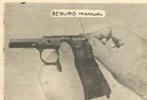
Figura 9. — Para sacar el seguro manual, monte el gatillo, tome el seguro y colóquelo en la posición intermedia entre Seguro y Fuego y tire hacia afuera de la armadura.
