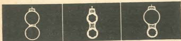
Esquemas de los tres tipos de cañones. De izquierda a derecha: escopeta con dos cañones superpuestos, rifle con dos cañones superpuestos y combinación de escopeta y rifle.
