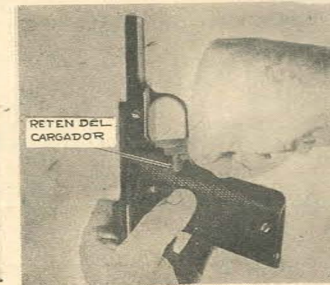
Figura 15. — Presione el retén del cargador hasta que quede al ras con la superficie izquierda de la armadura. Utilizando la rama más corta del muelle real como un destornillador, gire el tornillo 1/4 de vuelta contra la dirección de las agujas del reloj. El tornillo puede girar fácilmente. Si ello no ocurre, fíjese si el retén está bien a nivel con las paredes de la armadura. No se debe hacer fuerza para girarlo. Una vez que haya girado 1/4 de vuelta sacar el retén del cargador. (Recomendación: No utilice el brazo más largo del muelle real como destornillador). Para desarmar el retén del cargador, gire el tornillo retén en dirección de las agujas del reloj y separe las partes. Saque el disparador dejándolo deslizar desde la corredera colocada hacia arriba.
