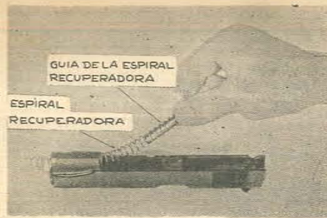
Figura 5. — Sacar la espiral recuperadora y su guía. Separar las dos partes haciéndolas girar.
