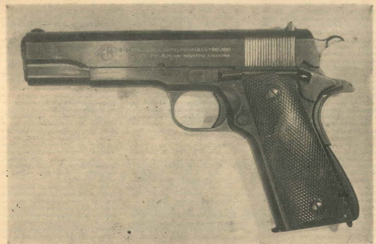
Pistola sistema "Colt" calibre 11,25 mm. (.45" ACP) construida en la República Argentina por la Fábrica Militar de Armas Portátiles "Domingo Maheú", ubicada en Rosario (Pcia. de Santa Fe).
