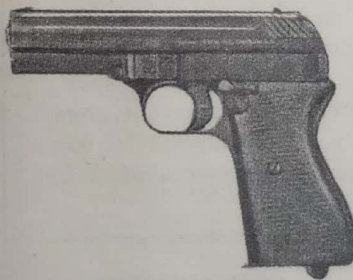
Pistola Máuser calibre 9 mm. Parabellum ejecutada experimentalmente al fin de la 1ª guerra mundial. Nunca fue construida en cantidad, se cree que sólo 25 ejemplares fueron hechos. El arma pesa 840 gramos vacía, posee un cañón de 10½ cms. con seis estrias de giro hacia la derecha. Mide 18½ cms. de largo total y 13 cms. de altura. La capacidad del cargador es de 9 cartuchos. Al no poder Alemania seguir construyéndola, a raíz de la prohibición del Tratado de Versalles, fue copiada por los checoslovacos en un modelo mucho más pequeño que el ilustrado en los calibres 9 mm. Browning corto (Modelo 1924) y 9 mm. Kurz M-22 checo (Modelo 1927), ambos cartuchos no son intercambiables.
