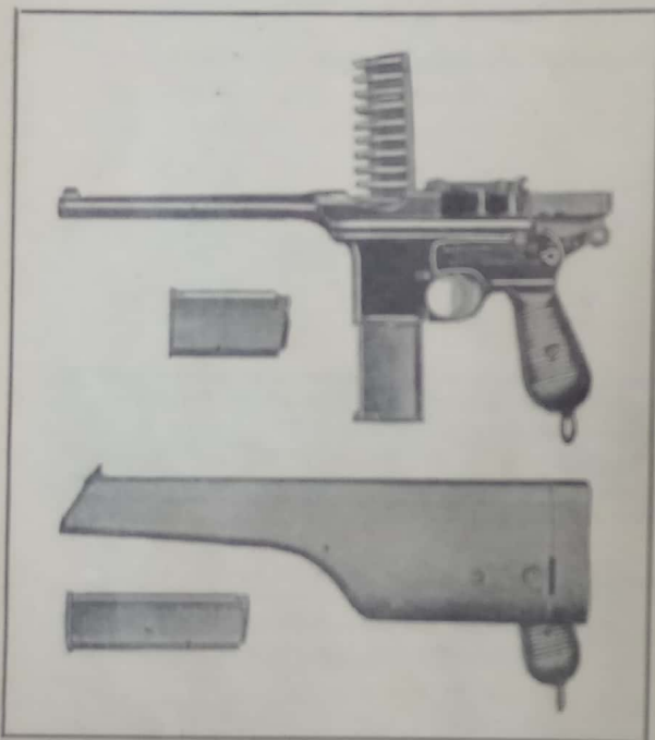
Astra 902, cal. 7,63 mm. Cargador fijo con capacidad de 20 cartuchos. Tiro automático y semiautomático. Cañón de 18,5 centímetros.
