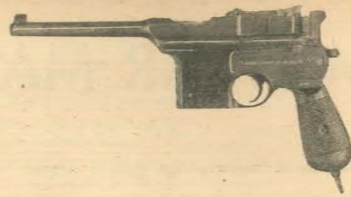
Astra 900, cal. 7,63 mm, de las primeras series, con pequeña anilla en el martillo. Posee una sola línea de inscripción: "Astra automatic pistol cal. 7,63 mm". Tiro semiautomático solamente.
