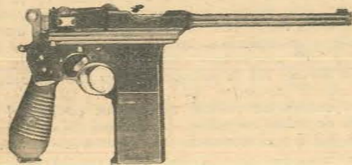
Astra 902, cal. 7,63 mm. Cargador fijo con capacidad de 20 cartuchos. Tiro automático y semiautomático. Cañón de 18,5 centímetros.
