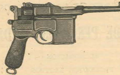
Pistola Máuser Modelo 1920, calibre 7,63 mm., cañón de 10 cm. Trae empuñadura cuadrangular y cachas de ebonita.
