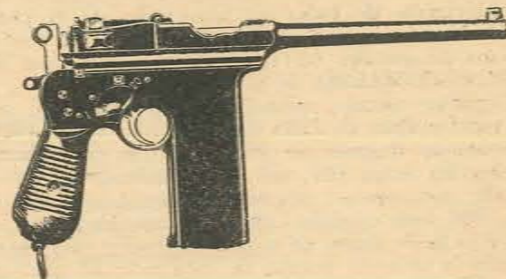
Pistola ametralladora Astra 902. Peso completo: 2,130 kg. El selector colocado sobre el lado derecho expone los números 1 y 20 para indicar tiro semiautomático y automático. 300 tiros por minuto.
