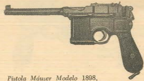
Pistola Máuser Modelo 1898, calibre 7,63 mm. Nótese el viejo seguro y distinto martillo.
