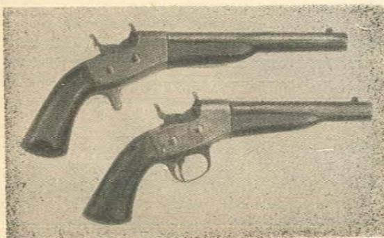
Arriba: Mecanismo de la acción del Rolling Block. Abajo: Dos modelos de pistolas fabricados por Remington que utilizaban el sistema de acción a block rotatorio.
