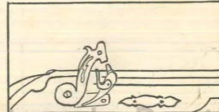
8) SISTEMA DE ENCENDIDO A PERCUSION POR FULMINANTES COLOCADOS EN DISCO
