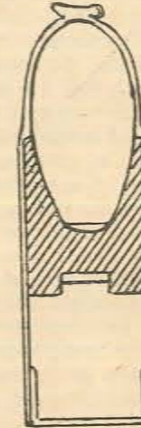
Fig. 5. - Cartucho del fusil Dreyse 1837. Corte mostrando sus partes componentes.
