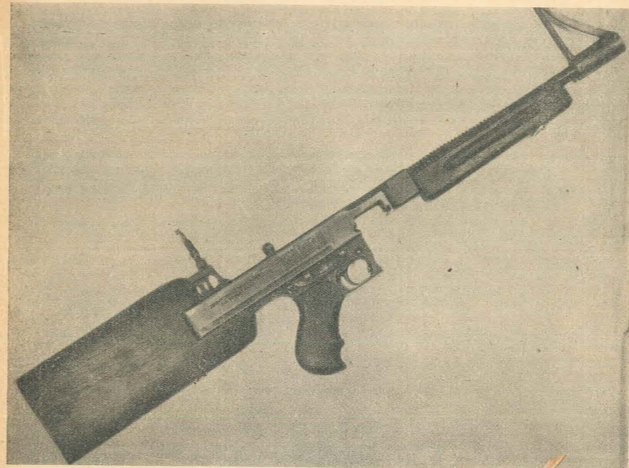
Thompson experimental realizada en 1941 y probada a principios de 1942 en Aberdeen (EE.UU.). Sus características especiales son una culata recta que obligó a levantar el aparato de puntería, su objeto: que el apoyo en el hombro del tirador sea la prolongación de una línea imaginaria que pase por el eje del ánima, para evitar que se levante demasiado la boca del arma en el tiro automático.
