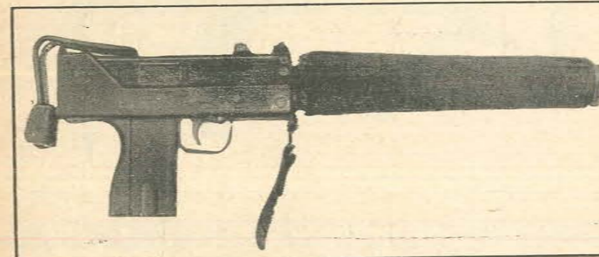
Pistola ametralladora Ingram M10 calibre .45, equipada con silenciador. El modelo M10 también se produce en calibre 9 mm. Parabellum.
