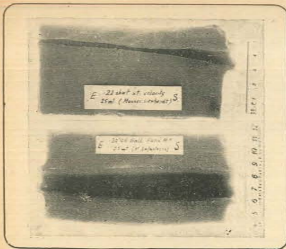
Fig. 42. - ACCION DE LOS PROYECTILES. Impactos logrados sobre bloques de jabón amarillo a 25 metros de distancia. En el corte de los bloques se observa la regularidad del trayecto cuyo diámetro aumenta ligeramente hacia la salida. Los proyectiles usados han sido no deformables; en la primera figura se ve el trayecto de un .22 Short de velocidad standard disparado con un fusil Mauser equipado con reductor Lienhardt. En la segunda se trata de un .30'06 "ball" disparado con fusil M-1. En este tipo de material no elástico el orificio de entrada presenta en general sus bordes salientes, aunque la orla del mismo se invierte hacia la cavidad, lo que no ocurre en el de salida, excepto cuando el jabón se ha deshidratado por envejecimiento luego del impacto.
