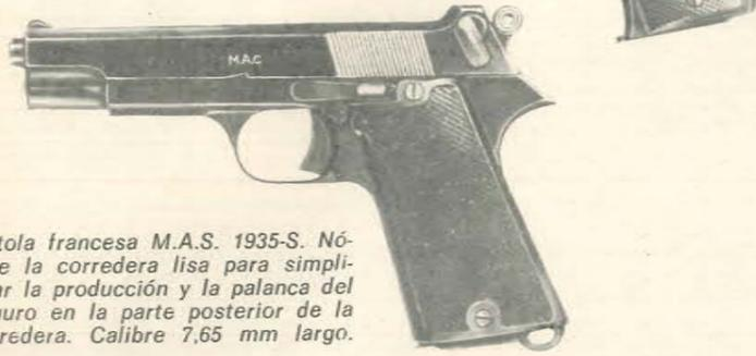
Pistola francesa M.A.S. 1935-S. Nótese la corredera lisa para simplificar la producción y la palanca del seguro en la parte posterior de la corredera. Calibre 7,65 mm largo.
