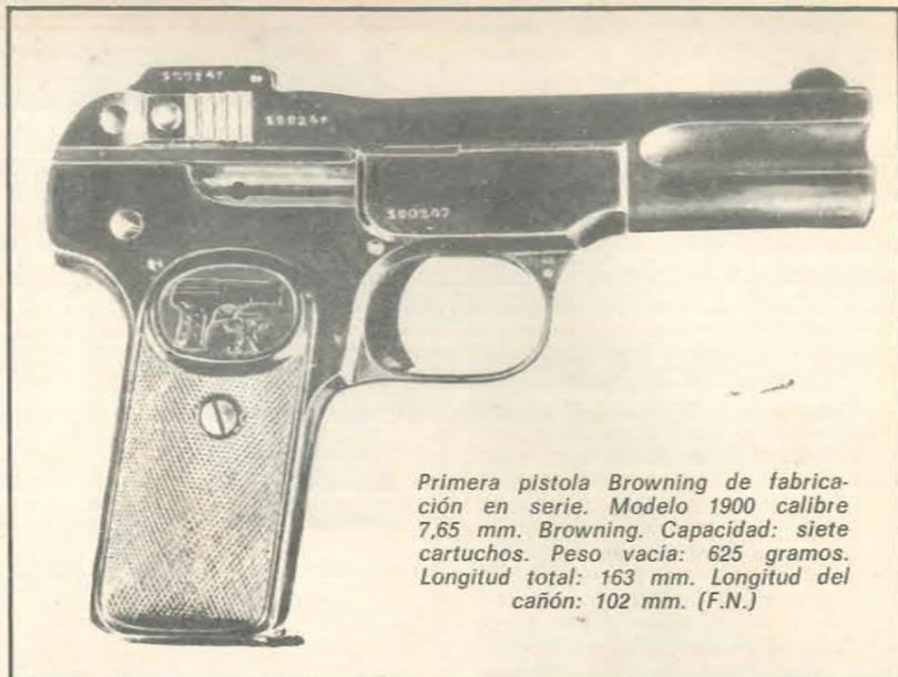
Primera pistola Browning de fabricación en serie. Modelo 1900 calibre 7,65 mm. Capacidad: siete cartuchos. Peso vacía: 625 gramos. Longitud total: 163 mm. Longitud del cañón: 102 mm. (F.N.)
