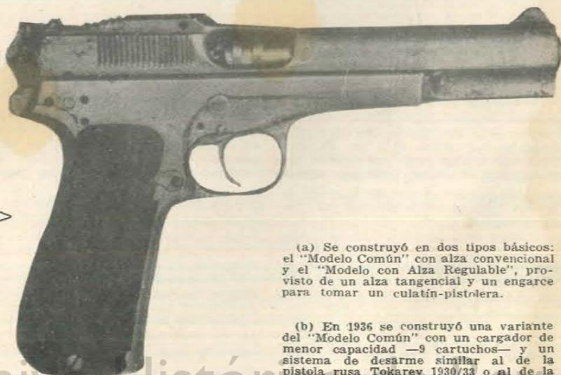
Prototipo hecho a mano hacia 1923 de la última pistola diseñada por John M. Browning: la Browning de Gran Potencia, construida en serie a partir de 1935. Este ejemplar cargaba 16 cartuchos de cal. 9 mm. Parabellum.
