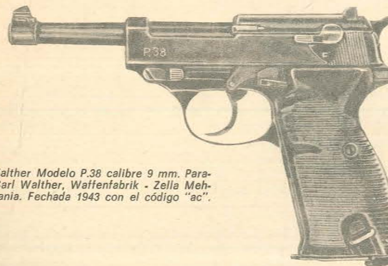
Pistola Walther tipo P.38, calibre 7,65 mm. Parabellum. Carl Walther, Waffenfabrik - Zella Mehlis, Alemania. Se trata de una variante del Modelo HP 1939-1941.
