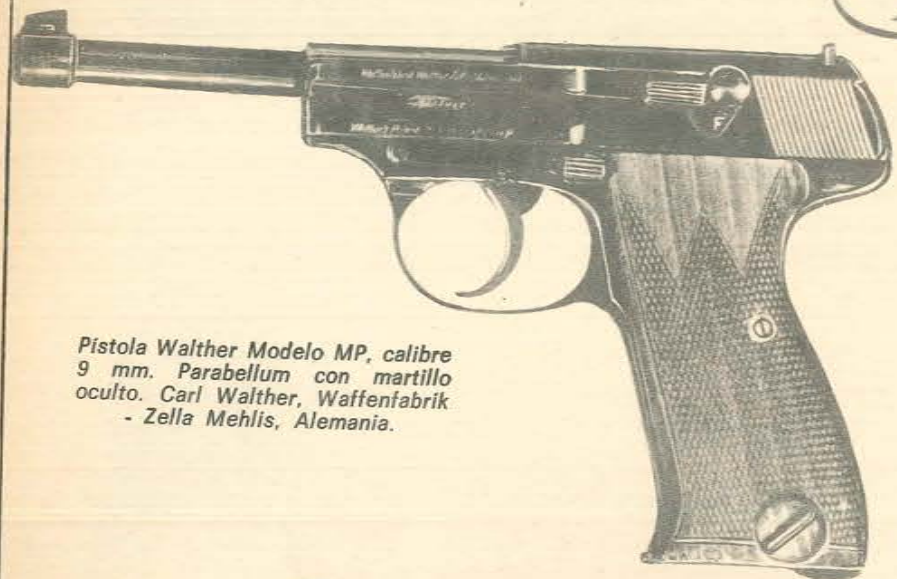
Pistola Walther Modelo MP, calibre 9 mm. Parabellum. Carl Walther, Waffenfabrik - Zella Mehlis, Alemania, con martillo externo, no apta para utilizar con munición 9 mm. Parabellum moderna. Pieza de colección.
