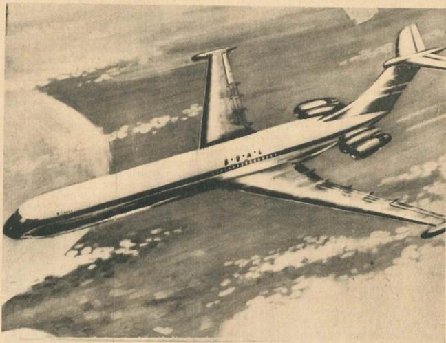
*El VC-10: Nuevo aparato de BOAC con cuatro turbinas en la cola para que el estruendo quede atrás cuando vuela a 1.000 Km por hora.*
