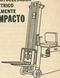
1.30 m. de largo x 0.75 (horquillas excluidas) con económicas baterías de 12 volts. 1.000 Kg. de capacidad hasta 4.00 m. de altura
