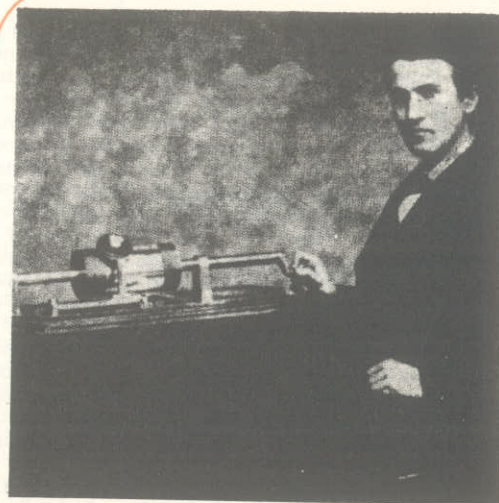
El joven Edison junto al invento con que más identificado se hallaba. Obsérvese el mecanismo manual de avance del cilindro.
