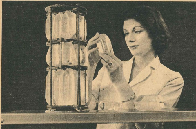
El cuarzo industrial costará la vigésima parte del cuarzo natural, y tiene la ventaja de producirse en masa y de no tener impurezas.
