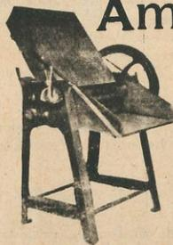
Armazón de hierro. Cilindros de acero. — Mando con palanca. — Cojinetes desmontables. — Sin cadenas. — Sin engranajes peligrosos.
