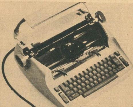
*La nueva y revolucionaria IBM: Las barras de los tipos y el carro móvil son eliminados y los reemplaza una esfera de plástico y níquel.*
