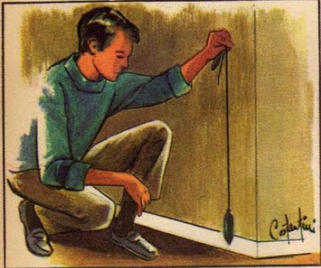
La **plomada** es un sencillo aparato, usado por los albañiles, que indica la dirección vertical.
