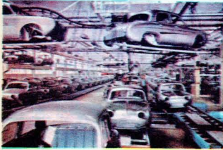
Las fábricas de automóviles son gigantes económicos. Observa cómo las carrocerías pasan por una cadena de montaje.
